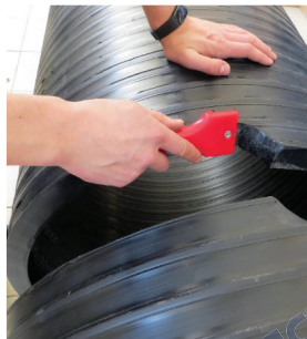
Рисунок 22 – Зона зачистки труб «СПИРОЛАЙН» при проведении сварочных работ снаружи свариваемых труб
