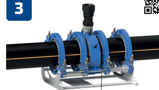
В аппарат устанавливается торцеватель,
