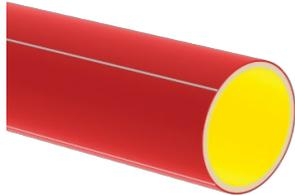
Трехслойные гладкие трубы со специальным внутренним слоем, не распространяющим горение. Обустройство трубных систем для защиты силовых электрических кабелей напряжением до 500 кВ. Методы прокладки: траншейная, бестраншейная (в том числе горизонтально направленное бурение).
