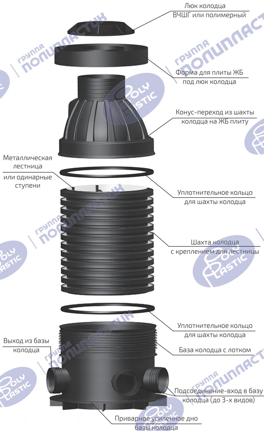
Рисунок 1 – Части колодца
