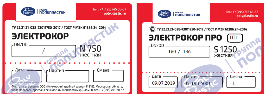
Рисунок 3 – Маркировка труб «ЭЛЕКТРОКОР» в виде ярлыка
