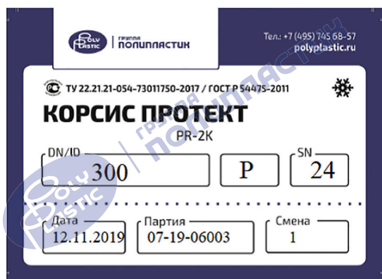
Рисунок 3 – Маркировка труб «КОРСИС ПРОТЕКТ» в виде ярлыка
