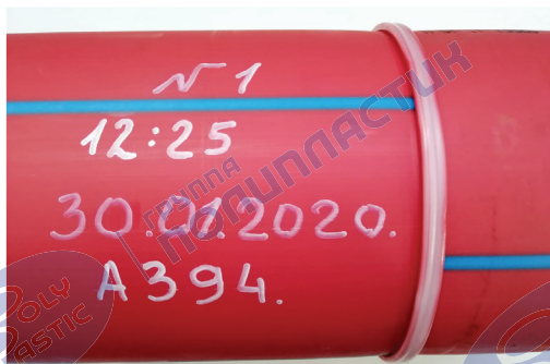
Рисунок 11 – Пример маркировки сварного соединения
