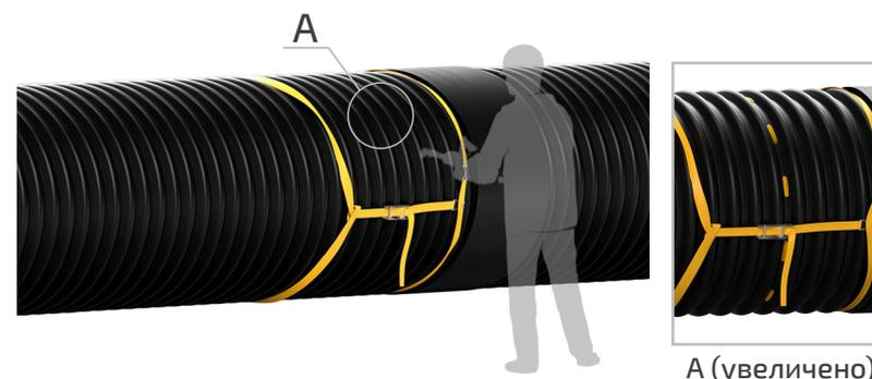
Трубы совмещаются и фиксируются стяжными ремнями. С помощью ручного экструдера стык фиксируется снаружи короткими швами. Стяжные ремни снимаются.
