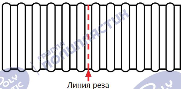
Рисунок 17 – Обозначение места реза
